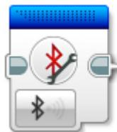
El modo Apagado apagará el Bluetooth en el Bloque EV3 que ejecuta el programa.
