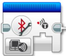
El modo Iniciar inicia una conexión con un dispositivo Bluetooth específico. Utilice la entrada [Conectar a](#) para ingresar el nombre del dispositivo. Se mantiene una conexión Bluetooth hasta que se usa el modo Cerrar conexión.
